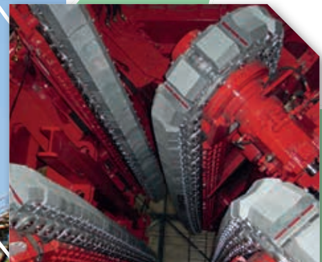
Tensioner voorzien van speciale buizentransportketting
