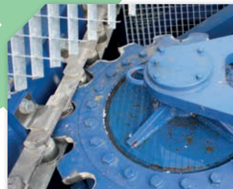
Lineaire kettingaandrijving van een kabelhaspel
