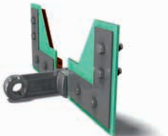
Aangepaste trog-schraperketting met kunststof schrapers
